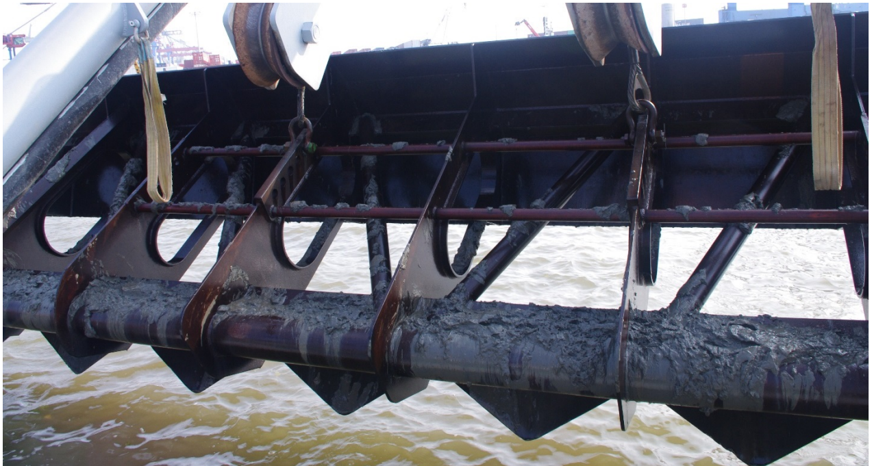
Abb. 8: Der 10m breite Schlickpflug des Bed-Levellers Kees Jr .
