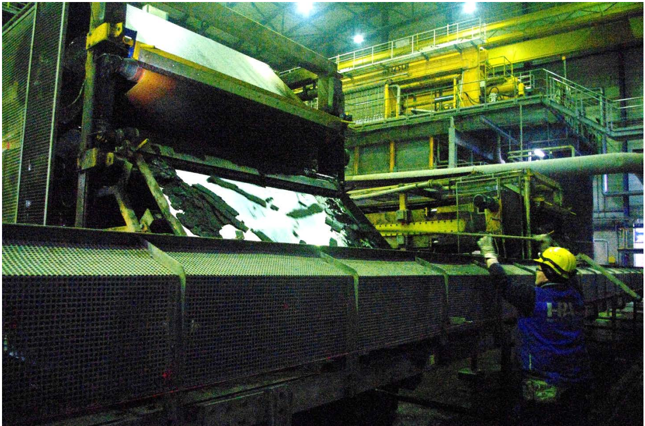
Abb. 15: Behandlung von belastetem Baggergut in der METHA.
