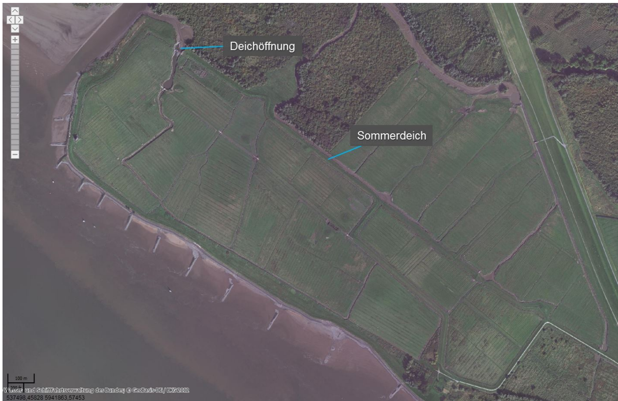
Abb. 4: Deichvorland Twielenflether Sand (Quelle: Geoviewer der Wasser- und Schifffahrtsverwaltung des Bundes)
