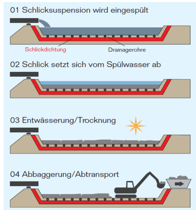
Abb. 18 Verfahrensprinzip der Entwässerungsfelder.
