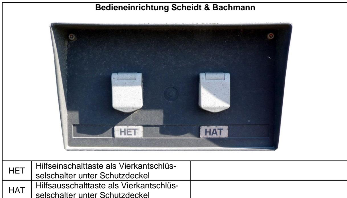
Die Vierkantschlüsselschalter werden durch das Drehen des Vierkants im Uhrzeigersinn bis zum Anschlag bedient. Für eine wirksame Bedienung ist die Stellung am Anschlag mindestens 1 Sekunde zu halten. Nach dem Loslassen kommt der Vierkantschlüsselschalter automatisch in die Grundstellung zurück.
