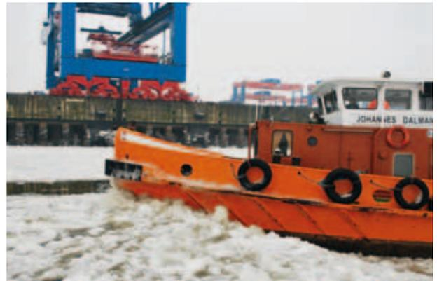
Kein leichter Job: Die Eisbrecher der HPA verhindern gefährliche Eisstaus, sichern die Deiche und unterstützen die Hafenschifffahrt.
