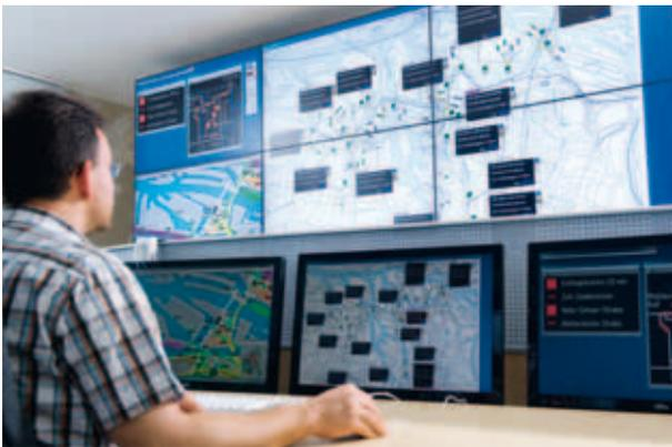
**Intelligente Ampelschaltung dank DIVA** 2012 wird auf der Haupthafenroute eine adaptive Netzsteuerung installiert. Die Signalprogramme der einzelnen Ampeln werden dann automatisch geschaltet – in Abhängigkeit vom jeweiligen Verkehrsaufkommen. Der Verkehr auf der Haupthafenroute läuft dann noch reibungsloser.
