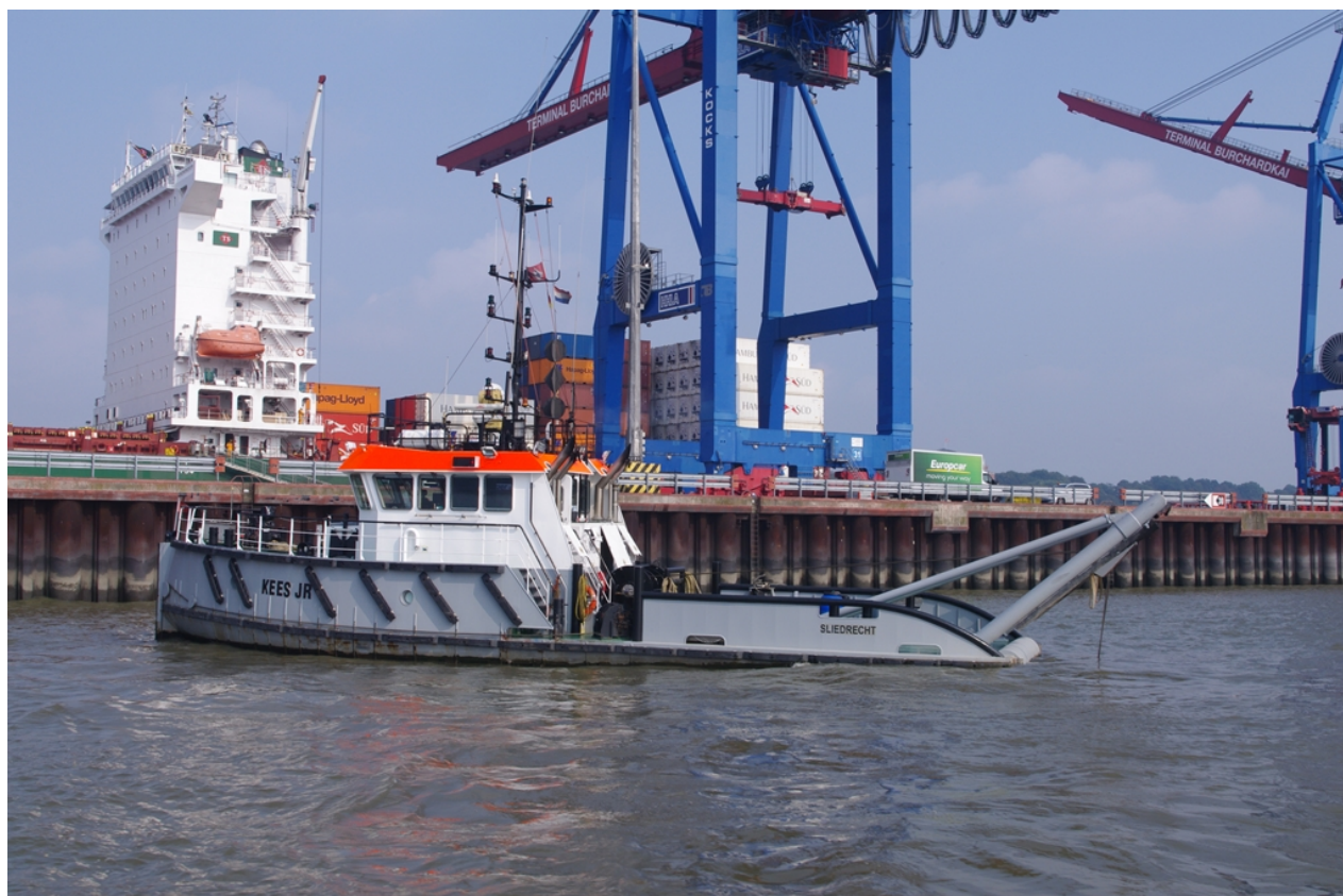
Abb. 9: Der Bed-Levellers Kees Jr im Einsatz. (Foto: B. Hochfeld, © HPA)
