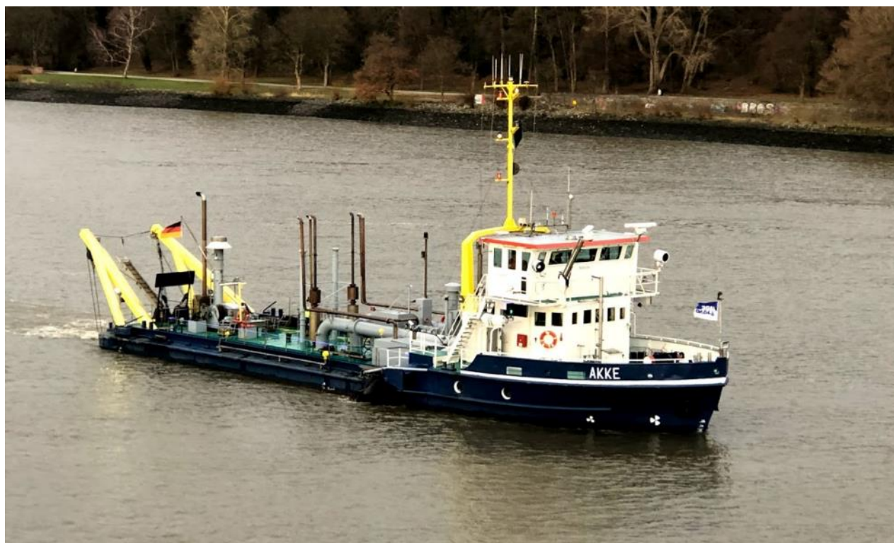
Abbildung 8: Wasserinjektionsgerät Akke im Einsatz auf der Riffelstrecke. (Foto: Christian Jonas).
