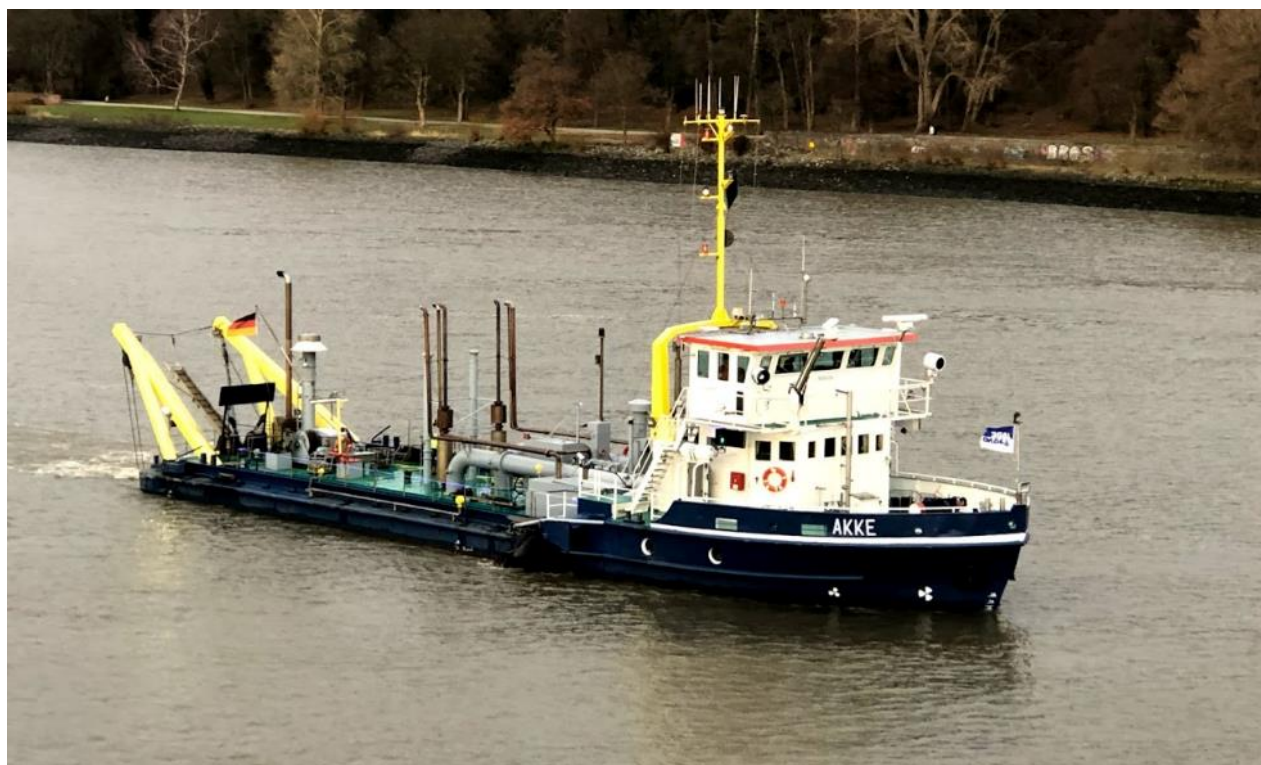
Abbildung 9: Wasserinjektionsgerät Akke im Einsatz auf der Riffelstrecke. (Foto: Christian Jonas).
