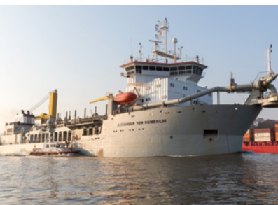
Laderaumsaugbaggerschiff „Alexander von Humboldt“
