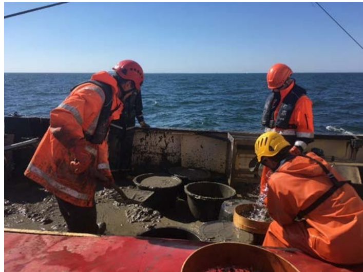
Abb. 7: Inhalt der Dredge wird an Bord entleert, in große Bottiche geschippt und anschließend mit Wasser gesiebt, um die Pfeffermuscheln zu sammeln.
