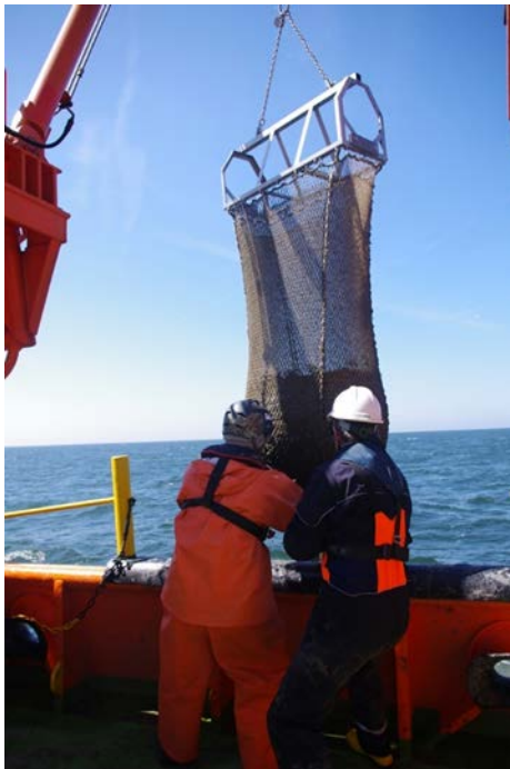
Abb. 5: Dredge, Typ "Kieler Kinderwagen", gefüllt mit Schlick aus der Nordsee, wird an Bord geholt.
