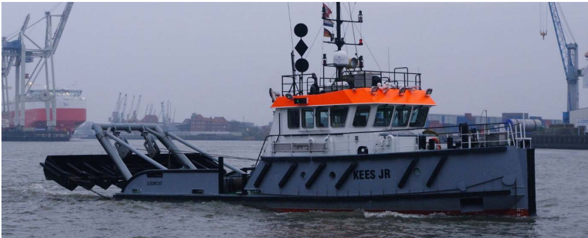
Abb. 2: Schlickpflug Kees Jr beim Einsatz in der Norderelbe. Foto: B. Hochfeld
