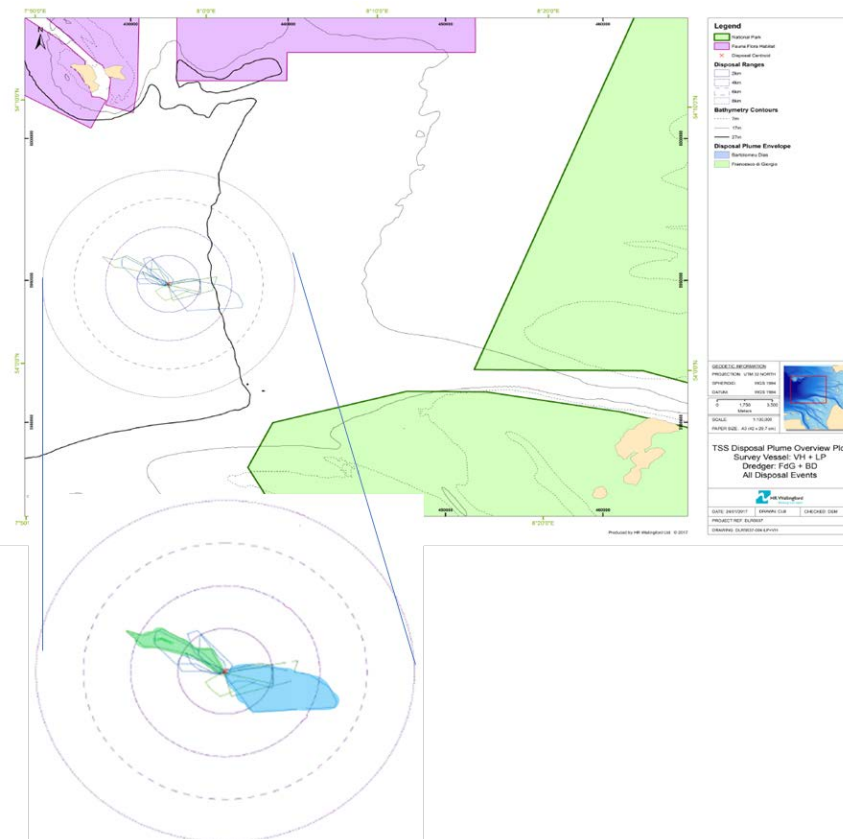
Abbildung 4.2-3 Ausbreitungsfelder der Verdriftungswolken während der ADCP-Kampagne 2016. Eingefärbt sind die längsten Verdriftungswege der Hopperbagger Bartholomeu Dia (blau) und Francesco di Giorgio (grün). Kreisentfernungen entsprechen 2-, 4-, 6- und 8-Km Radius. (Wallingford, 2017)
